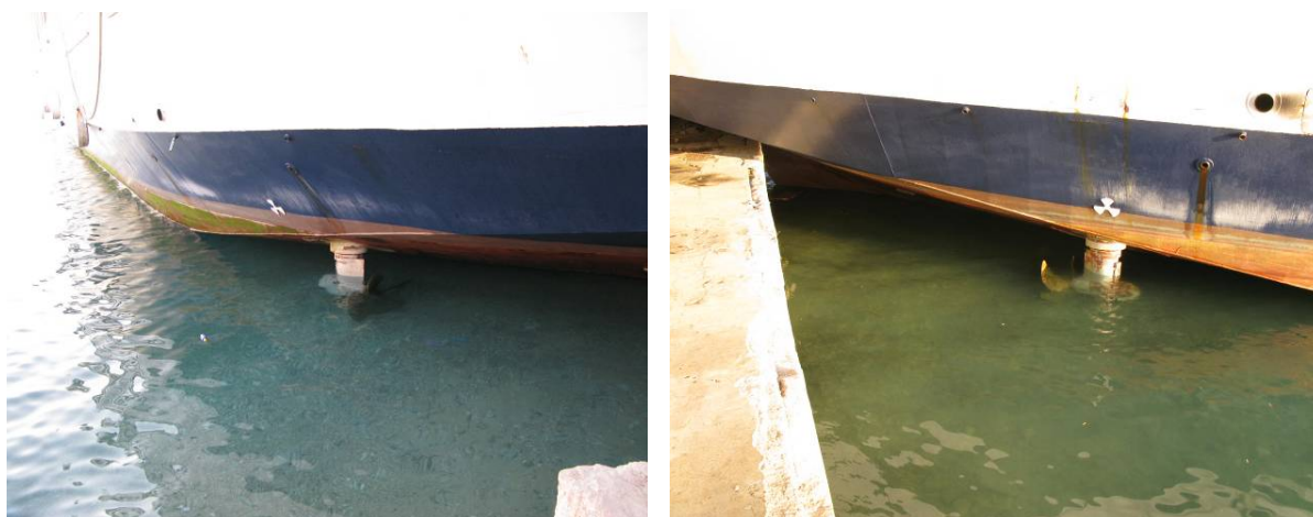
Slika 13. Nasukani dio broda s pramčanim propulzorima br.3 (lijevo) i br.4 oštećen (desno)
