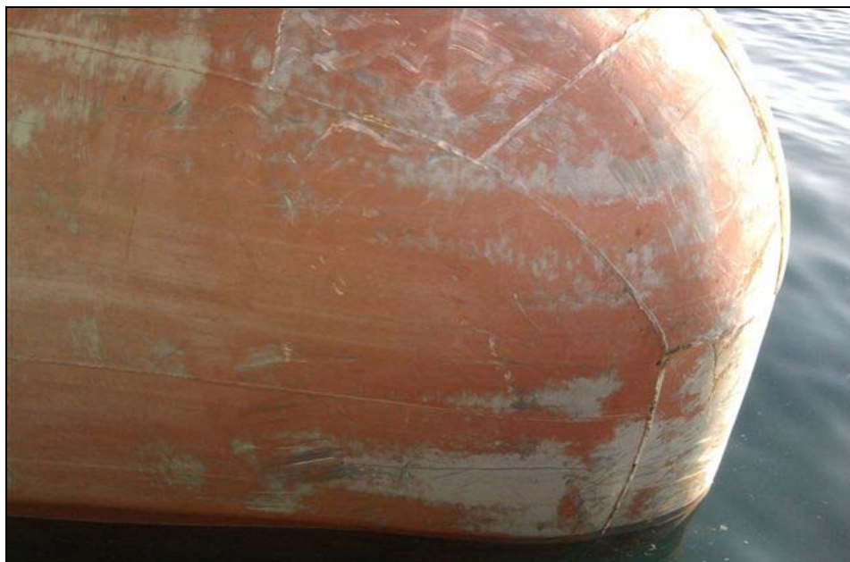
Slika 22. Oštećenje broda „Joerg N“ na pramcu
