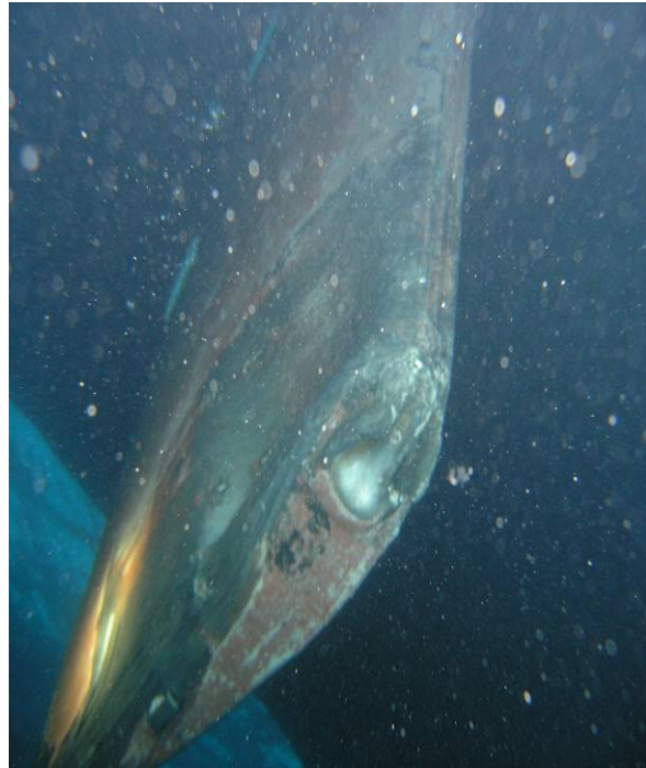
Slika 12 Oštećenja desnog kormila
