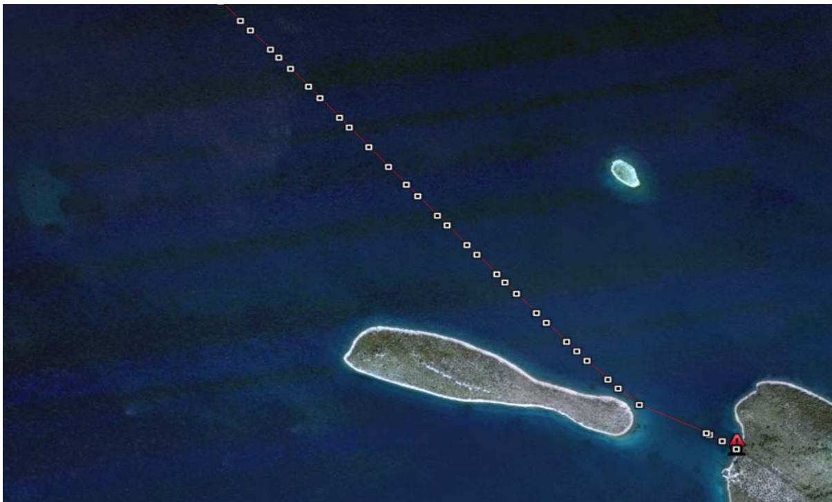
Slika 5 Kretanje broda „Marko Polo“ neposredno prije nasukanja – pozicije utvrđene obalnim AIS sustavom
