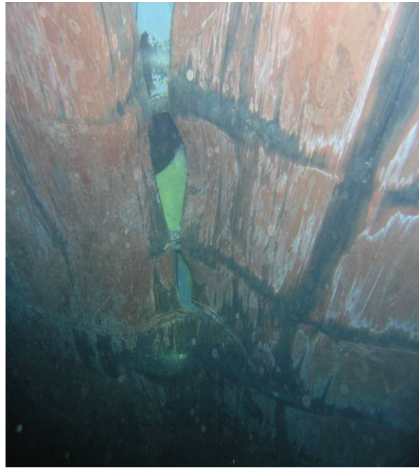
Slika 10 Oštećenja trupa s vanjske strane
